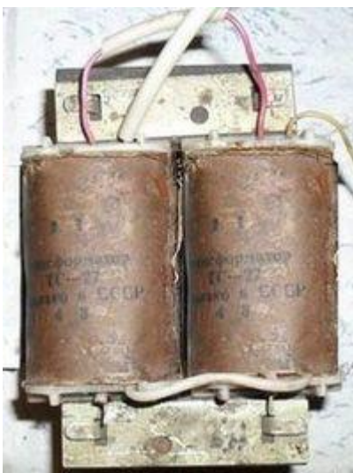
Рисунок 1. Внешний вид трансформаторов ТС-25, ТС-27.
