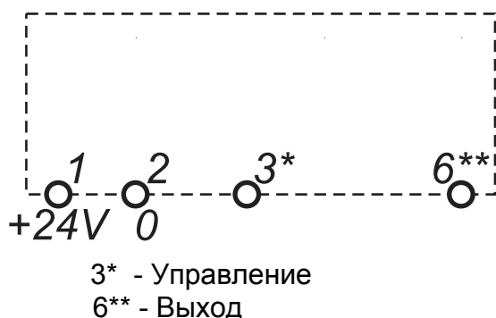
Рисунок 3 - Схема подключения реле ВЛ-63
